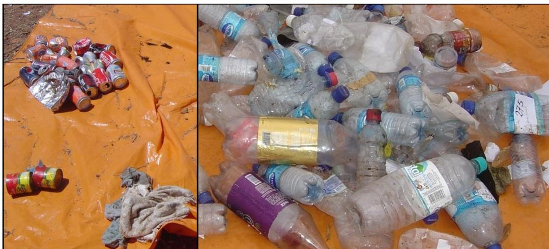
Figura 2 - Fotografias de componentes (metais ferrosos e não ferrosos, trapos e PET) separados da amostra de resíduos sólidos classe II, preparada para avaliação da composição física. Campus leste da UFERSA, Mossoró, 09/11/09.
