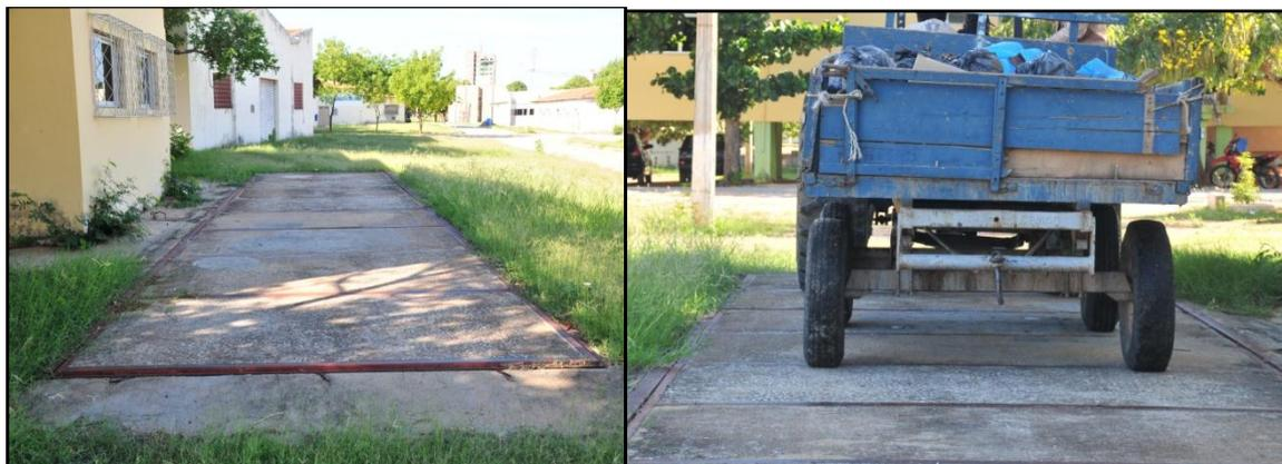
**Figura 4 - Balança rodoviária utilizada para pesagem dos resíduos sólidos, localizada ao lado do laboratório de sementes (fotografia a esquerda) e pesagem de resíduos sólidos coletados na UFERSA (fotografia a direita). Campus oeste da UFERSA, Mossoró, 23/11/09.**
